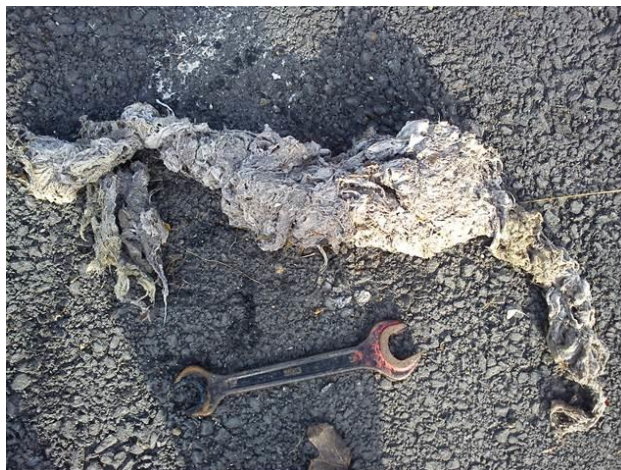
Obr. 2 Materiál z potrubí tlakové kanalizace, které se ucpalo vlivem kombinace podtlaku a nedostatečných proplachovacích rychlostí
